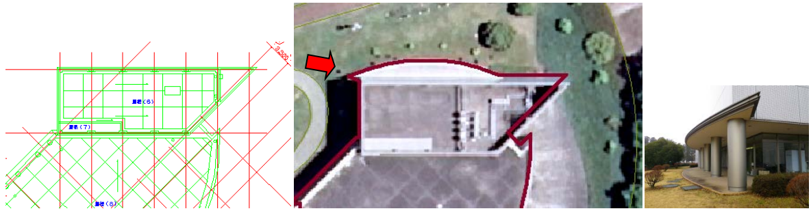
図 4-4-4 平面図の外壁と現況建物の外縁及び基盤地図情報（中図の赤線）の形状が一致しない例、中図矢印は右図（底）の撮影方向
