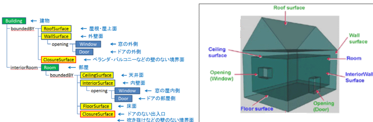
図-2-2-4 屋内空間を表す三次元モデルの構成（左図）とその概念図（右図、(OGC,2013)を修正）
